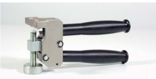
32 119 00 BOHLE Schnittlaufzange (für / for 6 - 15 mm Glas / glass) Ganzmetall, mit Stellschraube zur individuellen Einstellung auf die jeweilige Glasdicke, optimale Kraftübertragung, ideal auch für das Öffnen gerader Schnitte und Eckausschnitte etc.
