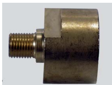
30 252 01 Dieser ADAPTER wird benötigt, wenn Fremdbohrer (Belgisches Gewinde) in unserem System verwendet werden sollen (1/2" Außen, 10 mm Innen). This adapter is required if foreign drill bits (Belgian thread) are used with our system (1/2" outside, 10 mm inside).
